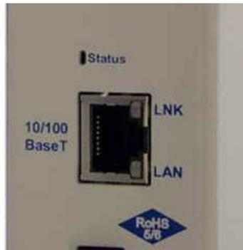
*Fig. 6.1 NetGuardian DIN Ethernet Port*
